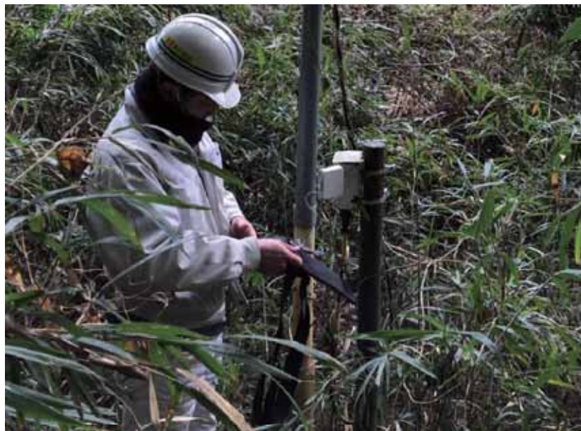
写真 2-3 地下水位のモニタリング調査
