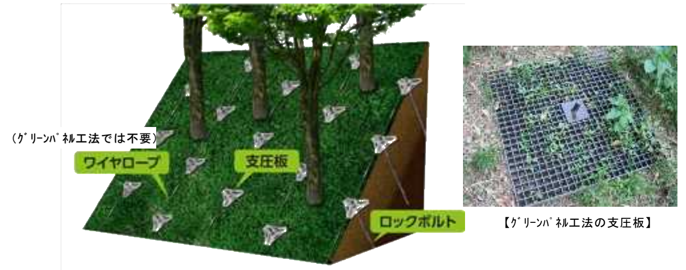
急傾斜地にアンカー等を直接設置することにより、斜面の崩壊を防止する。
